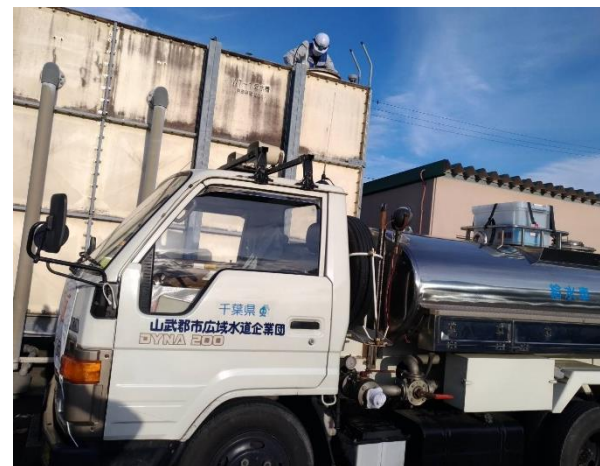
受水槽への給水
