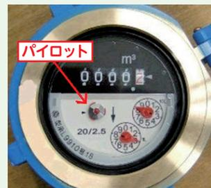
パイロットが少しでも回っていたら、漏水している可能性があります。水道管の修理は山武水道の指定給水装置工事事業者へ依頼してください。
