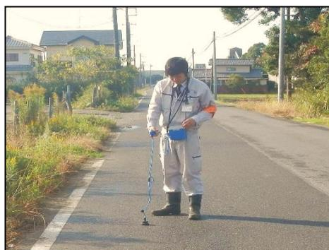
漏水調査（音聴検査）
